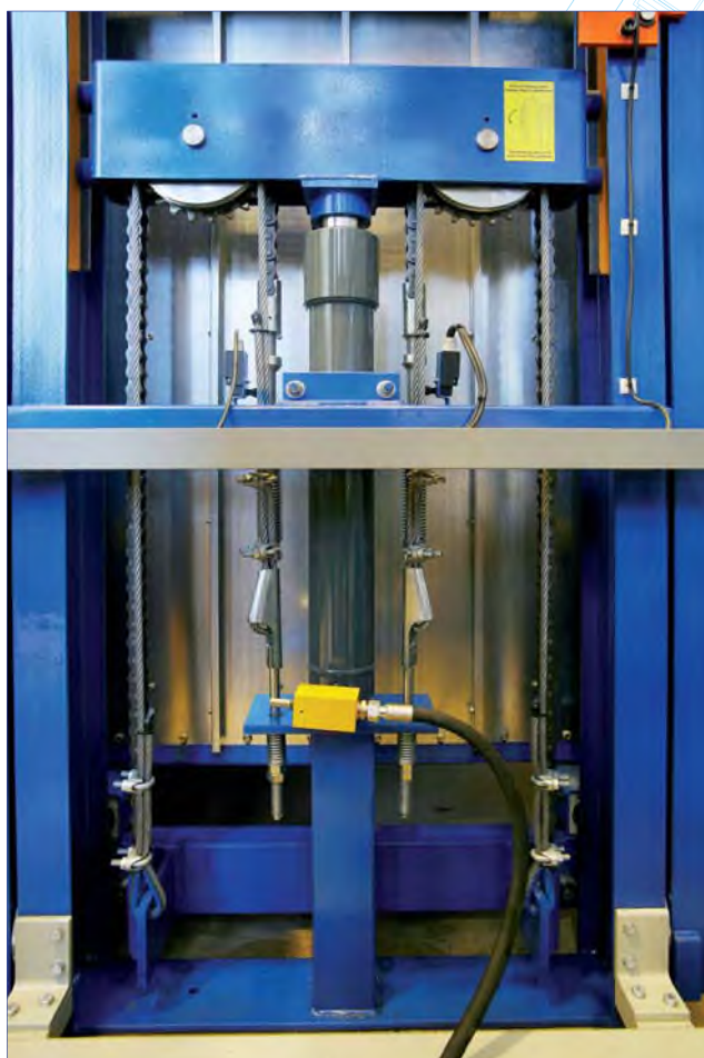
Рис 7. Вид сзади на нижнюю часть направляющей стойки, с смонтированными на неё частями подвески.
